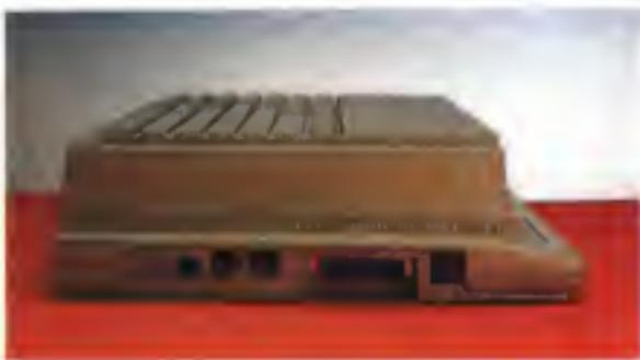
Sul lato sinistro è presente la tradizionale interfaccia MIDI unitamente ad un'interfaccia per il collegamento in rete. Lo slot cartidge ROM, la presa per la tastiera ed il mouse (sparticolato duplicato anche a destra) ed il pulsante di reset.
